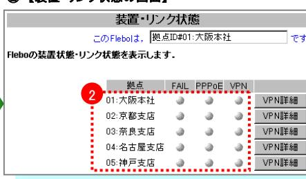
② 再起動が完了したため、VPN通信が出来ている状態を示しています。
