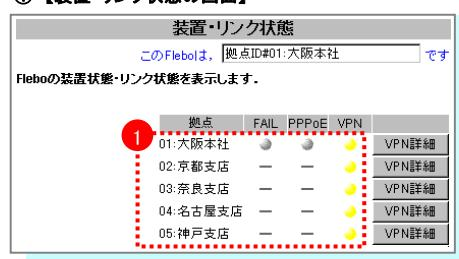
① 再起動ボタンクリック後に「装置・リンク状態」画面に遷移します。再起動中なためVPN通信が出来ていない状態を示しています。
